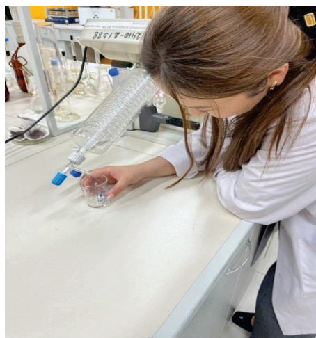
Сурет 8 – Суретте дистилляциялық колба, суытқыш және қабылдағыш ыдыс арқылы эфир майын жинау процесі көрсетілген
