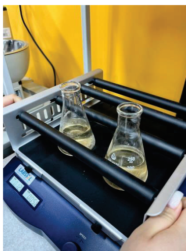
Сурет 12 – Гидролаттың тұрақтылығын қамтамасыз ету үшін шейкерде араластыру
